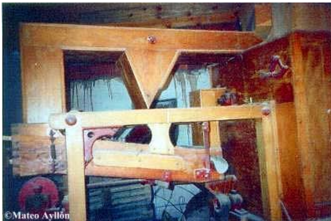
Detalle de la seleccionadora utilizada para la limpieza del grano, situada en la primera planta
